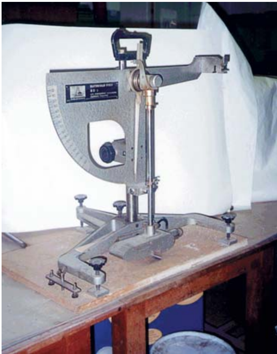
Маятниковый прибор МП-3 для измерения коэффициента сцепления
